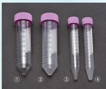
①③ポリスチレン製 (PS製) ②④ポリプロピレン製 (PP製)
